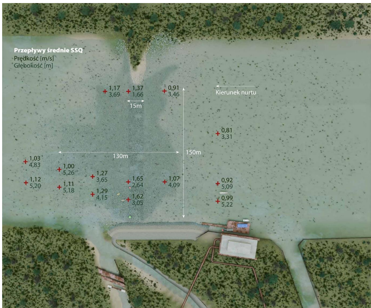
Rys. 8. Przepływy przy średnim stanie wody (wskazanie na wodowskazie przy Bulwarach Wiślanych SSQ \approx 131 cm).
